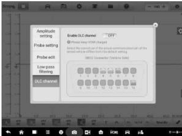
Рисунок 7-61. Первый пример окна настройки канала DLC
