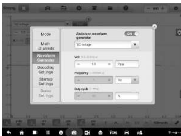
Рисунок 7-21. Пример окна настройки генератора сигналов
