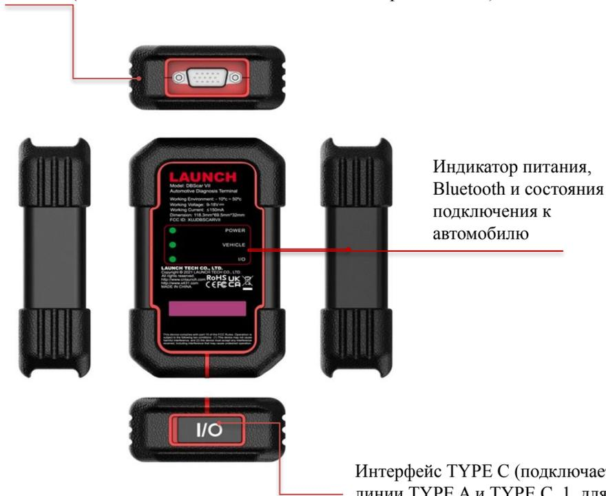
Интерфейс TYPE C (подключается к линии TYPE A и TYPE C, 1. для проводной диагностики 2. для передачи данных)
