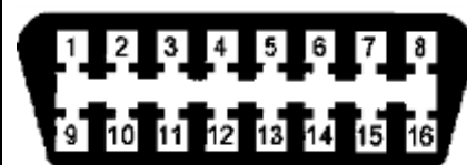
OBD-16F, вид со стороны пайки контактов
