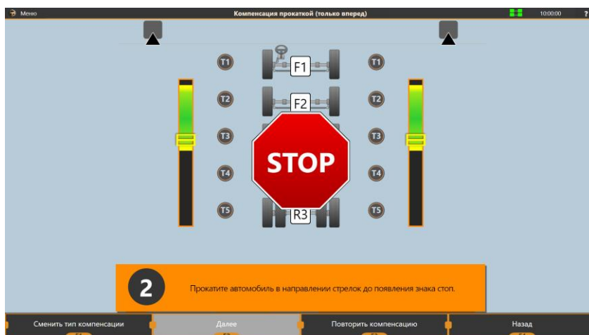
Рисунок 3.36 – Прокатка автомобиля вперёд
