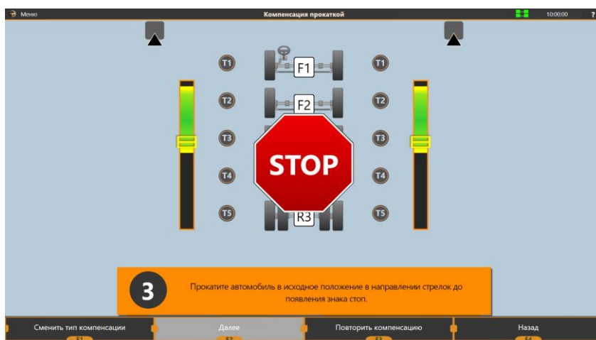
Рисунок 3.31 – Прокатка автомобиля вперёд
