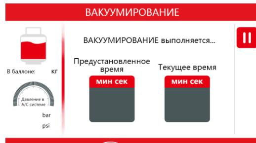
4) Если вы выберете проверку утечек, программа вакуумирования перейдет в программу проверки утечек.
