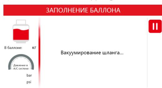
6) По завершении вакуумирования действуйте, согласно подсказкам на экране. Для перехода к
