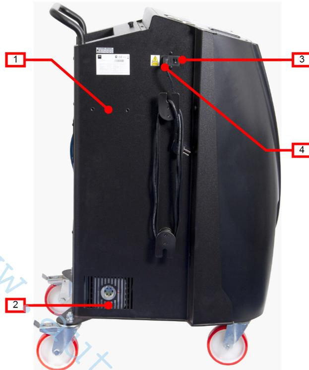
1. Крепежные отверстия для комплекта промывки
