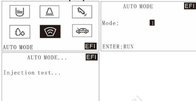
Автоматическая проверка содержит все вышеупомянутые испытания (проверку 15-секундного впрыска, проверку скорости холостого хода, средней скорости, высокой скорости, переменного ускорения и переменного торможения, а также проверку изменения ширины импульса впрыска). Эта функция позволяет произвести более полную проверку производительности форсунок, имитируя различные условия работы автомобильного двигателя.
