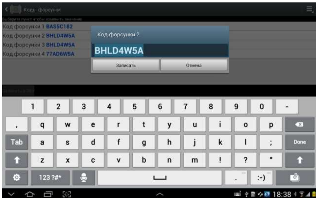
Запись кодов форсунок (Ivaco 1FA)
