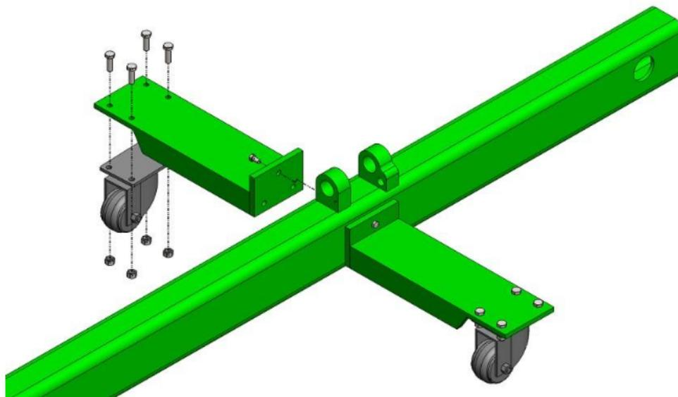
2. Соедините нижнюю балку и гнездо с осью, Закрепите гнездо и основную стойку с помощью крепления.
