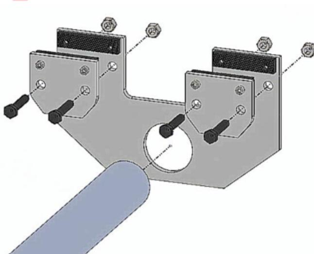
7. Закрепите два конца трубчатой опоры с зажимами на двух штативных опорах.
