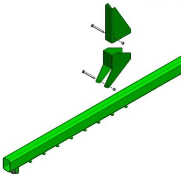
6. Зафиксируйте зажимы болтами M10 и закрепите их на трубчатой опоре.
